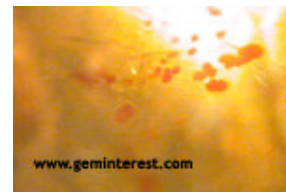
Img11: Inclusions probablement colorées par du fer dans un zircon haut
