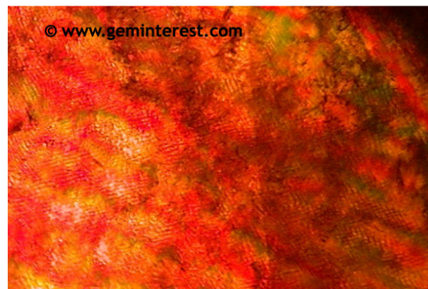
Img 4 : « treillage » ou probable réseau organisé de dislocations (donnant l'aspect trouble sur cette prise de vue) et/ou tensions internes vues entre filtres polarisants croisés.
