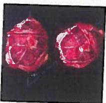
Figure 3 : Le « faux » cristal de rubis (ci-dessous) polarise la lumière suivant ce qui aurait dû être l'axe C.
