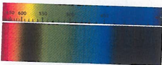
Figure 2 : Spectre observable dans le rubis synthétique et le rubis naturel. Seule l'intensité des bandes change suivant l'intensité de la couleur du rubis naturel ou synthétique.
