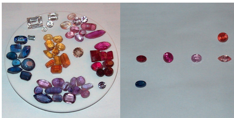
Figure 6 : A gauche lot de corindons synthétiques obtenus par fusion (Verneuil). Note : Le saphir synthétique vert clair n'est pas sur la photo | A droite lot de corindons synthétiques obtenus par dissolution anhydre ( Chatham). Les deux corindons synthétiques obtenus par dissolution hydrothermale ne sont pas représentés ici.
