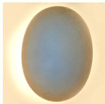
Figure 4 : Effet de décoloration de la périphérie de la pierre quand elle est vue en immersion de le diiodométhane.
