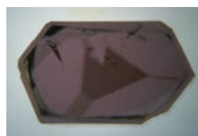
Fig1: Liddicoatite: Tranche taillée perpendiculairement à l'axe C.
